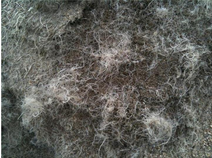
*Fibrelastic*: Mit starren und elastischen Kunststofffasern armierte Rasentragschicht.
