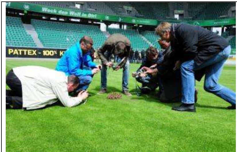
Abb.4 Das System zur Armierung der Tragschicht interessierte die DRG-Teilnehmer ganz besonders, sodass der Ausstich bevorzugt fotografiert wurde.
