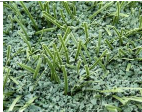
Abb.7: Kunstrasen wird mit einem Sand-Gummigranulat verfüllt, damit die Fasern aufrecht stehen.
