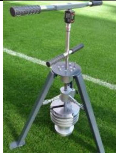
Abb. 7: Stollenschergerät zur Messung der Scherkräfte einer Rasenarbe in Newton Meter (NM).
