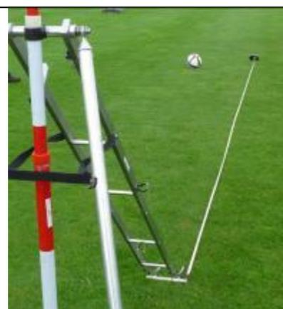
Abb. 5: Ballroll-Strecke von 5,75 m bei einer Starthöhe von 100 cm und einem Gefälle von 45 °.
