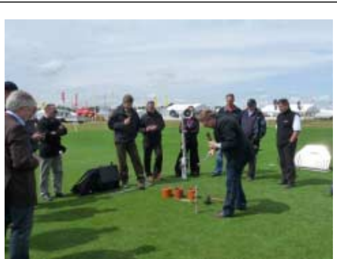
Messung der Bodenlockerung mit dem Penetrometer (Dr. Prämaßing, Mitte) und Ermittlung der Scherfestigkeit mit der Flügelsonde (Prof. G. Bischoff im Vordergrund)
