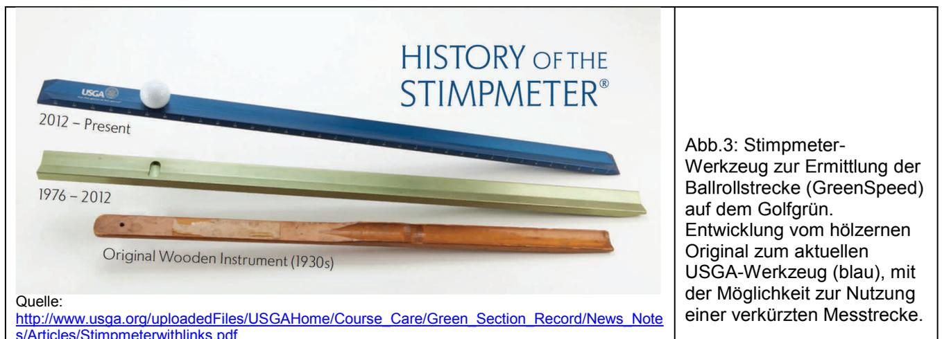
Abb.3: Stimpmeter-Werkzeug zur Ermittlung der Ballrollstrecke (GreenSpeed) auf dem Golfgrün. Entwicklung vom hölzernen Original zum aktuellen USGA-Werkzeug (blau), mit der Möglichkeit zur Nutzung einer verkürzten Messstrecke.
