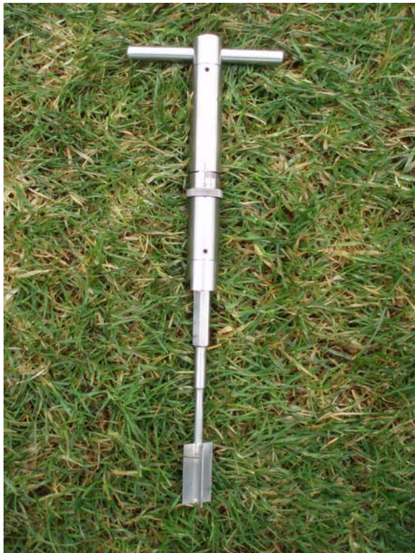
Abb. 2a+b: Bisheriges Messgerät (Flügelsonde) zur Bestimmung der Scherfestigkeit (links) ist abgelöst durch Drehwiderstandsgerät (rechts). (Fotos: H. Nonn)
