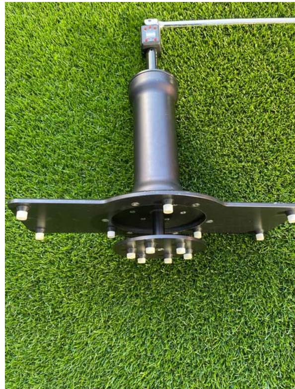
Abb. 2a+b: Bisheriges Messgerät (Flügelsonde) zur Bestimmung der Scherfestigkeit (links) ist abgelöst durch Drehwiderstandsgerät (rechts). (Fotos: H. Nonn)
