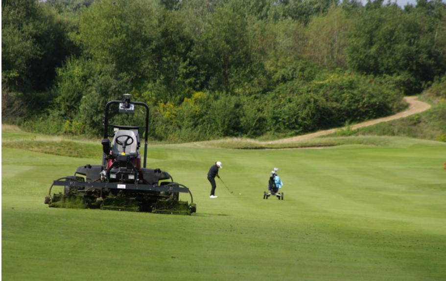
Abb.3: Professioneller Einsatz eines Fairway-Mähers auf dem Golfplatz mit autonomer, georeferenzierter Steuerung durch GPS-Daten, (Foto, ILOS 2019).
