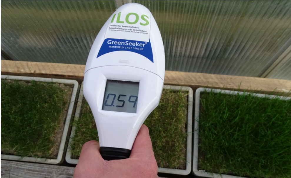
Abb.3: Einsatz des GreenSeeker handheld crop sensor zur Prüfung des NDVI-Wertes. (Foto: K.G. Müller-Beck)
