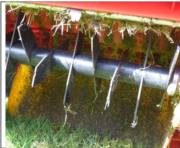
Abb.3: Vertikutiermesser schneiden senkrecht in die Rasenarbe und entfernen Rasenfilz und abgestorbene Pflanzenteile. Die Gräser werden leicht verletzt, bestocken sich aber rasch durch Neutriebbildung, bei guter Nährstoffversorgung.
