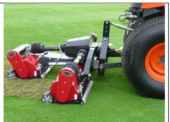
Abb. 2: Vertikutier-Einheiten mit unterschiedlichen Arbeitstiefen.
