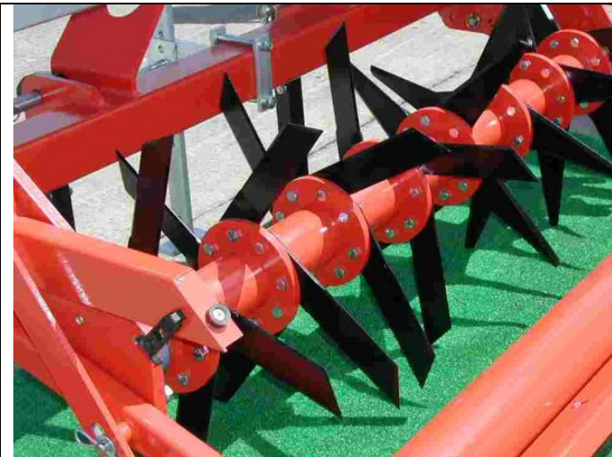
Abb.4: Schlitzgerät mit Sternwalze. Fotos: K. Müller-Beck
