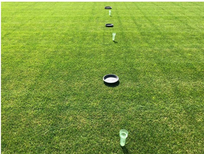
Foto 4: Beispiel eines Versuchsaufbaus für die Überprüfung der Beregnungsmenge und der Verteilungsgleichmäßigkeit. (Foto: Dr. H. Nonn)
