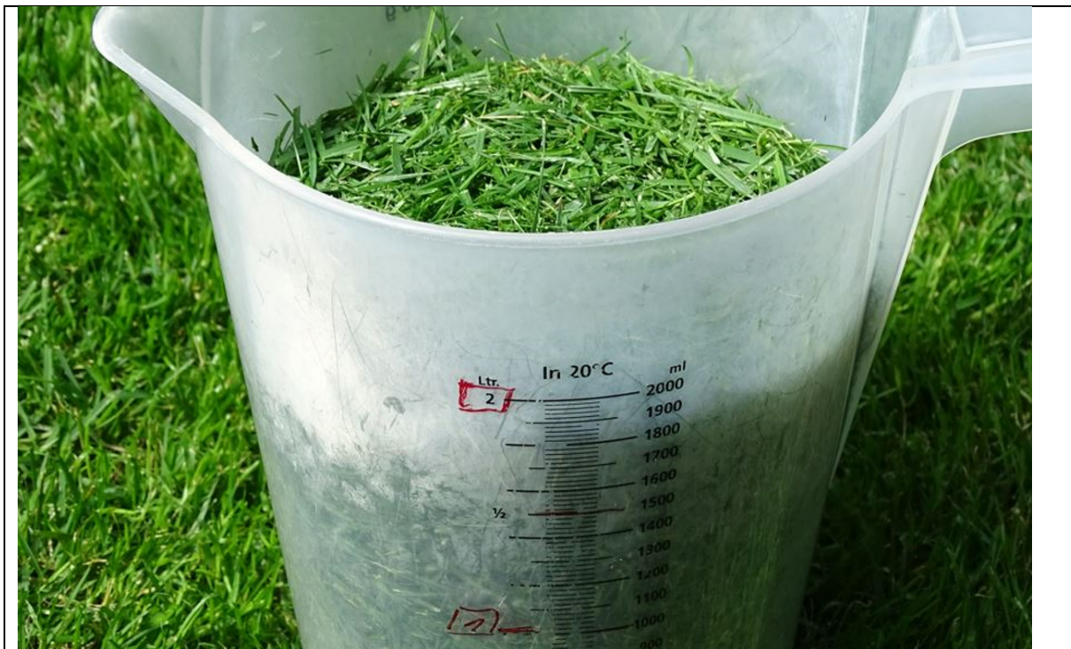
Abb.2: Ermittlung des Schnittgutvolumens in ml/m 2 gibt Hinweise auf Vitalität der Gräser. Foto: Dr. K.G. Müller-Beck
