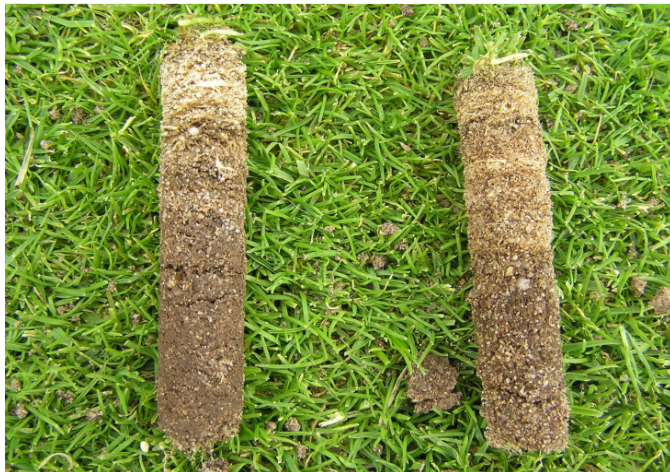
Abb.1: Bodenkerne aus einer Rasentragschicht mit „Thatch“- und „Mat-Horizont“. Foto: K.G. Müller-Beck
