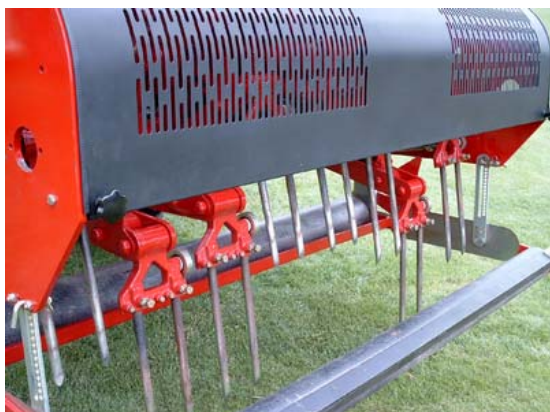
Foto 7: Lockerungsgerät mit einstechenden Vollzinken und Brecheffekt (Foto: H. Nonn).
