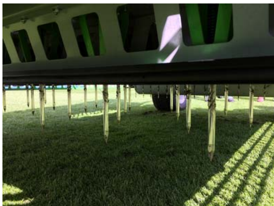
Foto 8: Lockerungsgerät mit Druckluftzinken (Foto: H. Nonn).
