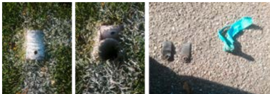
Abb. 21: Rasenspielfeld (Sportplatz). Links: abgedeckte Hülse für Eckfahne kann problemlos vom Mähroboter überfahren werden. Mitte: Gleiche Hülse mit senkrecht platzierter Abdeckung nach einem Spiel führte zu Schäden an den Messern (rechts). Rechts: beschädigte Messer und Tape-Reste von blockiertem Mähkopf.
