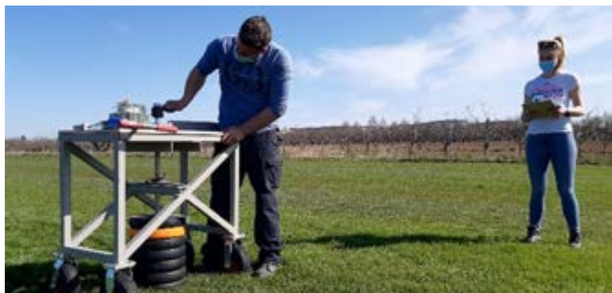
Abb. 5: Stollenschergerät-Eigenbau nach EN 15301-1:2007 auf dem Rasenversuchsfeld in der Versuchsstation Agrarwissenschaften der Universität Hohenheim.
