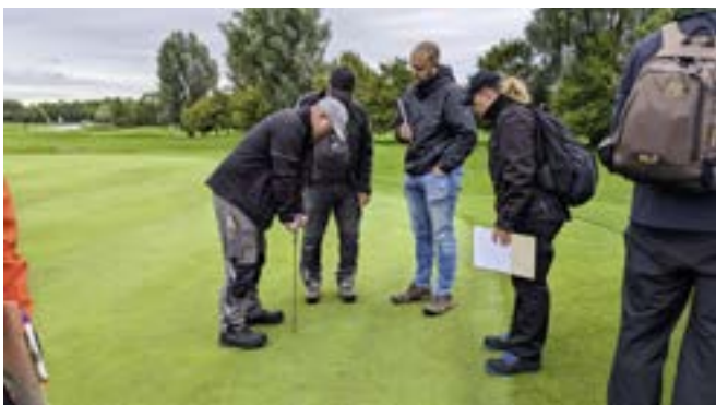
Golf Club St. Leon-Rot, Bodenprüfung auf dem Grün mit dem Penetrometer
