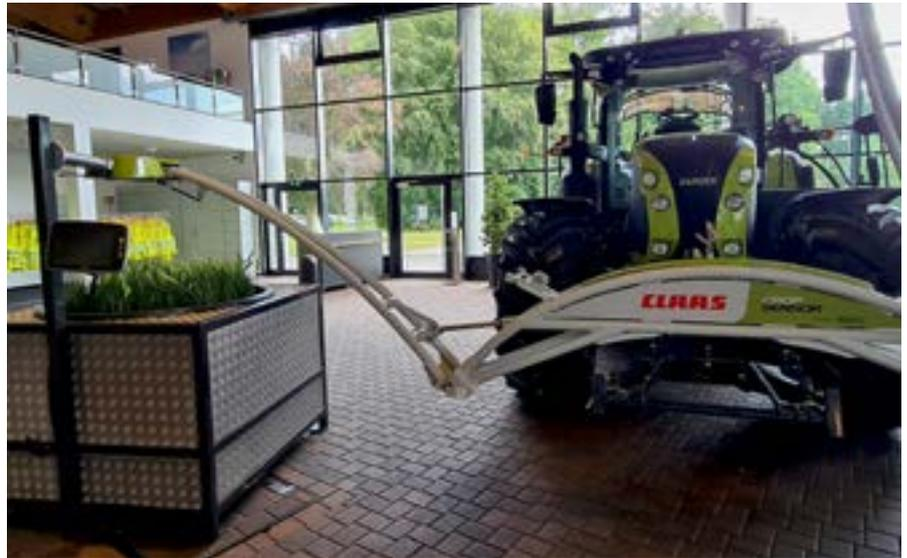
Abb. 3: Frontanbau eines Crop-Sensors zur Steuerung der stand ortspezifischen Düngermenge.
