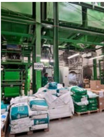
Abb. 8: Mischanlage für Rasenmischungen, im Vordergrund Einzelkomponenten.
