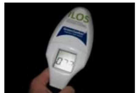
Abb. 9: GreenSeeker zur Ermittlung des NDVI.
