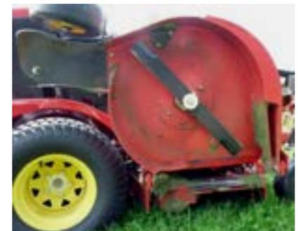
Abb. 2: Mähdeck eines Sichelmähers. (Foto: K.G. MÜLLER-BECK)
