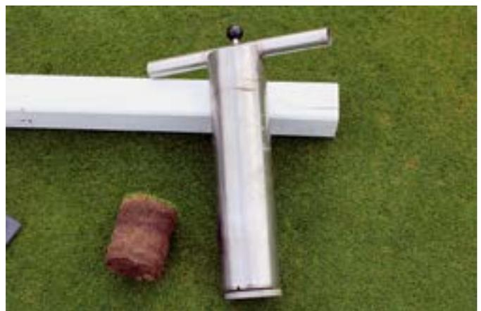
Abb. 5: Stechzylinder zur Entnahme von Wurzelproben.
