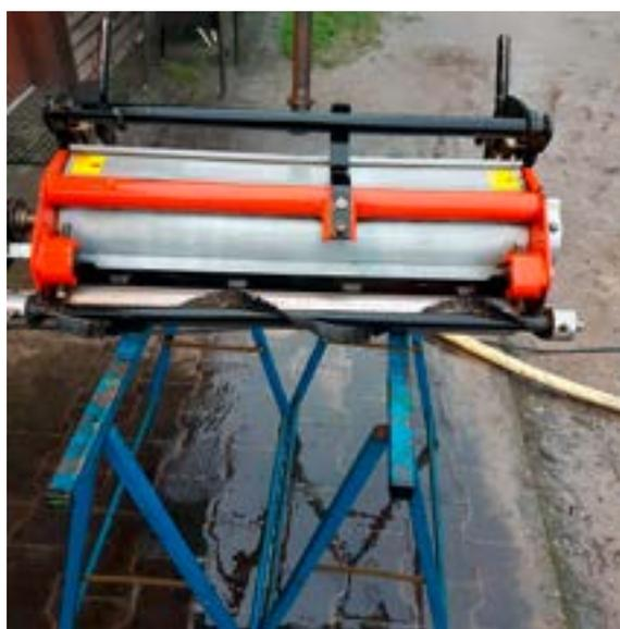
Vorher-Nachher-Vergleich: Einfache Reinigung der Grünsmäher-Einheiten mit ...? Backofenspray! Komplett von vorne und hinten einsprühen, nach einer Einwirkzeit von 20-30 Minuten abspritzen und ggf. an den „schwierigen“ Stellen mit Bürste/Topfschwamm nacharbeiten. Etwaiges Nachfetten nicht vergessen!
