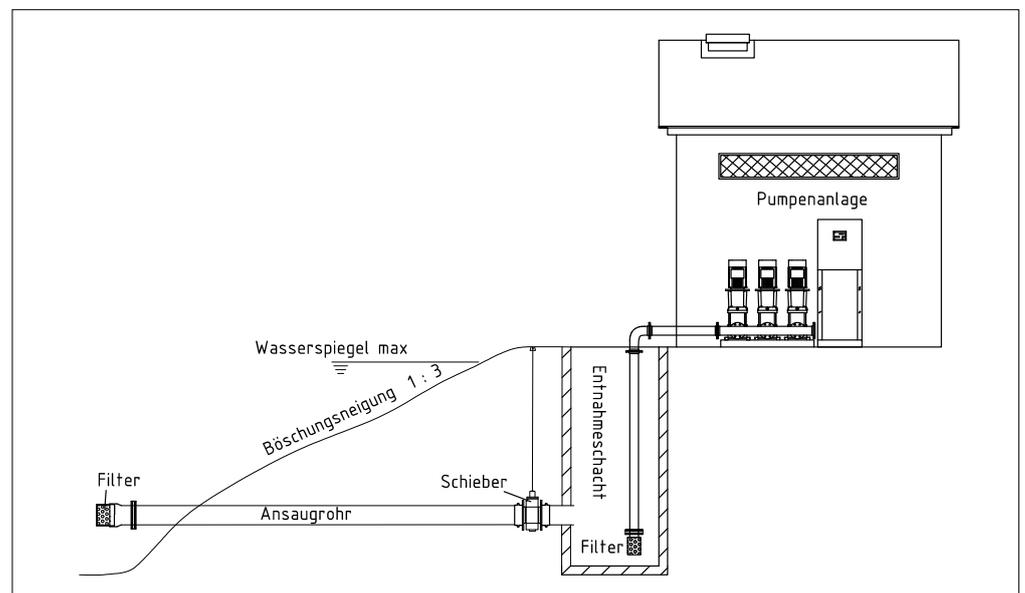
Abb. 1: Einbausystem einer oberirdischen Pumpenanlage
