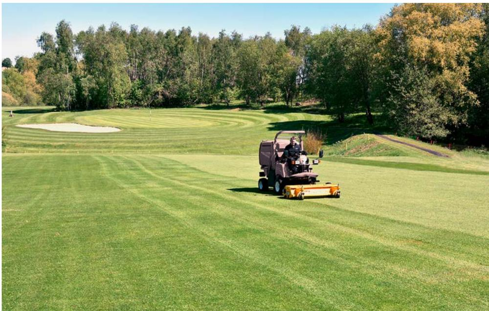
**Durch einfach auszutauschende Vertikutiermesser wird die Grasnarbe vom Rasen einige Millimeter angeritzt, dadurch können Unkräuter und Moose entfernt werden. Außerdem wird gleichzeitig der Boden belüftet, so dass eine optimale Bewässerung sichergestellt ist.**
