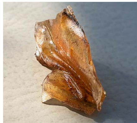
Verklumpte, ausgetrocknete und erhärtete Masse, die im Diesel gefunden wurde.
