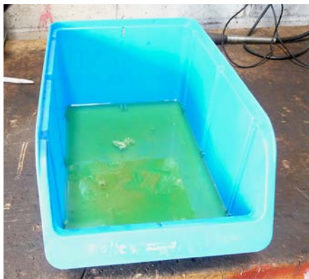
Abgelassener Diesel; bereits mit etwas Abstand ist der verunreinigte Dieseldieselkraftstoff klar zu ersehen.
