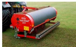
aus. Trotz seines geringen Gewichts beträgt die maximale Arbeitstiefe 250 mm bei einer Arbeitsbreite von 195 cm.
