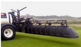
Abb. 2: Feldspritze mit Spritzschirm ohne Plane (ELLIS, 2015).
