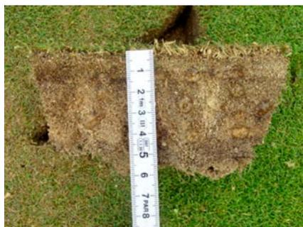
Abb. 5: Hydrophobie in Filzschicht (Thatch) und Übergangszone (Mat) eines Golfgrüns.
