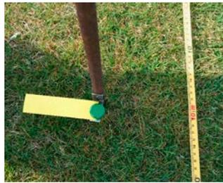
**Abb. 5: Befestigungsstangen mit Magnethalterung für Teststreifen.**
