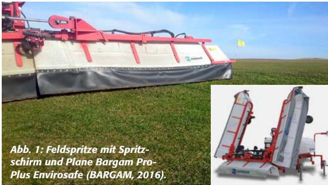
Abb. 1: Feldspritze mit Spritzschirm und Plane Bargam Pro-Plus Envirosafe (BARGAM, 2016).
