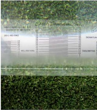
**Schnitthöhenmessung mit dem Bodenprofilanalyse Prisma**
