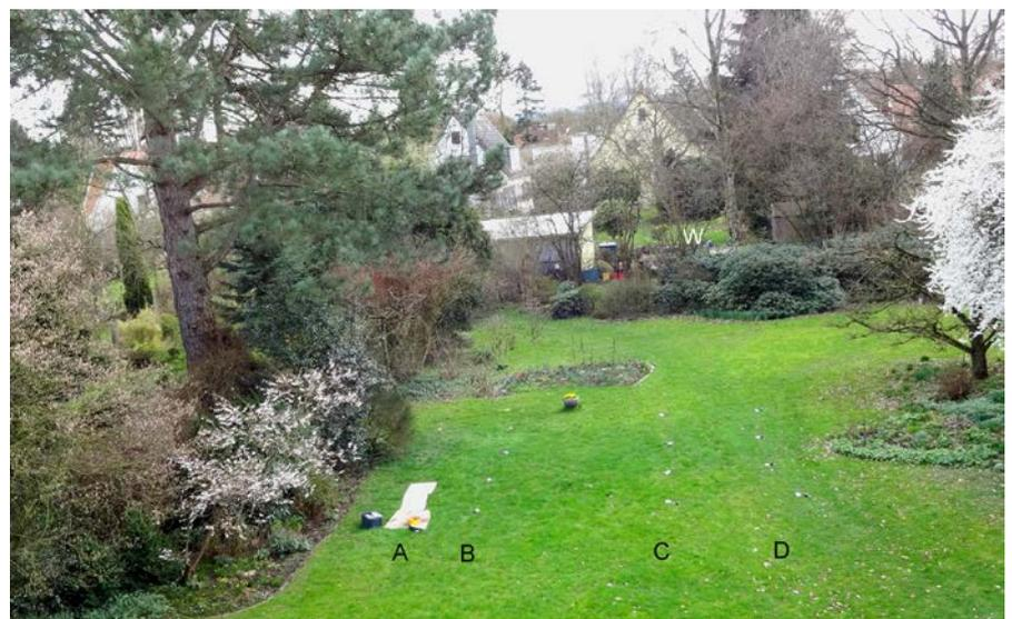
Abb. 1: Untersuchungsfläche am 21.03.2017. Die Positionen der CO<sub>2</sub>-Sensoren sind als weiße Punkte im Mittelgrund erkennbar. A bis D markiert die vier Sensorreihen. Die Sensoren der Reihe A sind bis auf einen bereits vergraben. Der winterliche Trampelpfad im Bereich der Sensorreihe D ist als leichte Verdunklung der Grasnarbe erkennbar. Der „Wald“-Vergleichsstandort am hinteren Gartenrand ist durch W markiert.
