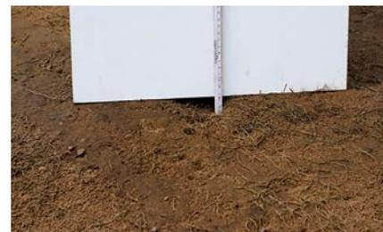
Abb. 10: Glatte Fasern liefern beim Abfräsen einer Hybrid-Tragschicht eine bessere Ebenflächigkeit.
