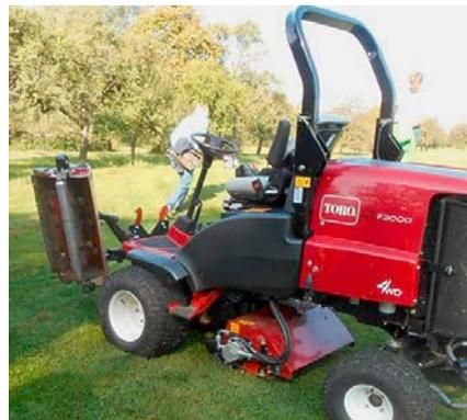
Abb. 6: Feinschlegelmäher von TORO für Rasenflächen, wie beispielsweise Semi-Rough. (Foto: M. Bocksch)
