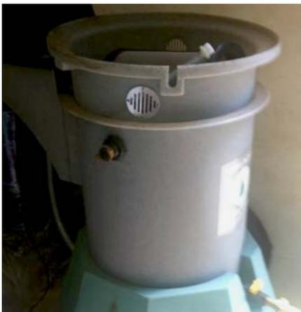
Abb. 1: Extraktionsbehälter zur Herstellung von Komposteluat
