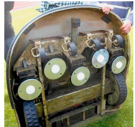
Abb. 7: Fünf Schneideinheiten mit je drei kleinen Messern arbeiten unter dem Mähroboter. (Foto: M. Bocksch)
