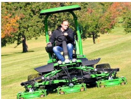
Abb. 5: Der neue John Deere Kontouren-Mäher 9009 A mit schnell zu verstellender Schnitthöhe an den Decks im Einsatz. (Foto: M. Sax)
