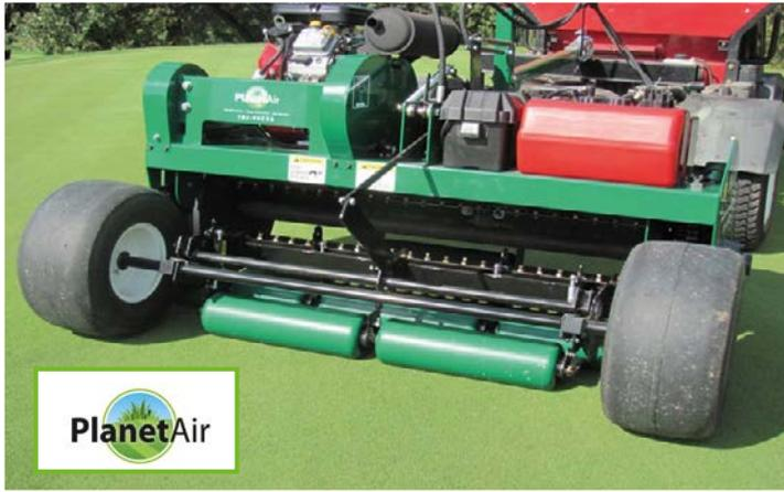
PlanetAir-er belüftet und glättet Flächen. Großvolumige Belüftung in einer Tiefe bis zu ca. 9cm durch PlanetAir-Bewegung. Seine Schnelligkeit ist unschlagbar; 18 Grüns in 4 Stunden!
