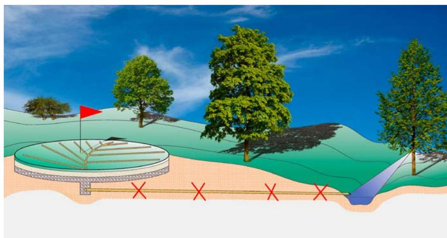
Abb. 1: Drainagen sollten nicht wie im Bild dargestellt in einen Entwässerungsgraben, sondern in eine Versickerungs- und Verdunstungsmulde geführt werden.
