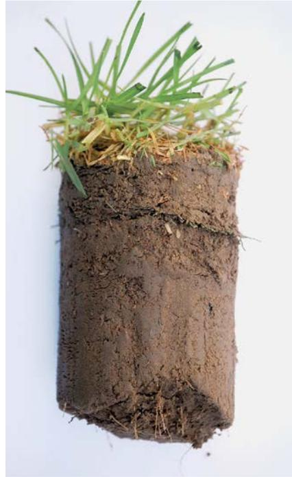
Abb. 5: In etwa 4 cm Tiefe eingebaute horizontale Maulwurfsbarriere.
